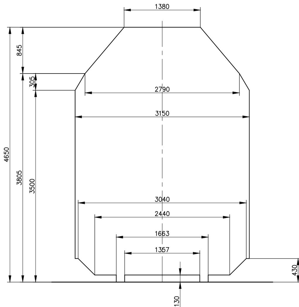
Габарит погрузки на железных дорогах колеи 1435 мм:
