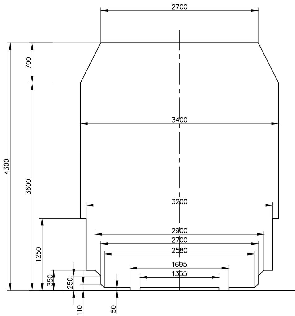
Габарит погрузки на железных дорогах колеи 1435 мм: 3Ч
