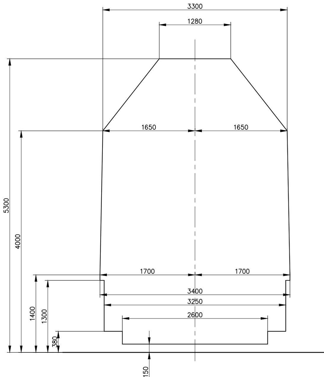
Льготный габарит погрузки на железных дорогах колеи 1520 мм:
