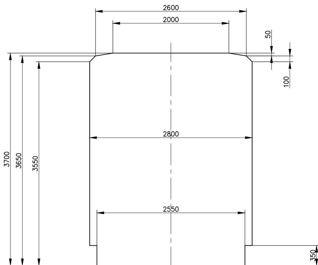
Габарит погрузки на железных дорогах колеи 1000 мм: ВЖД
