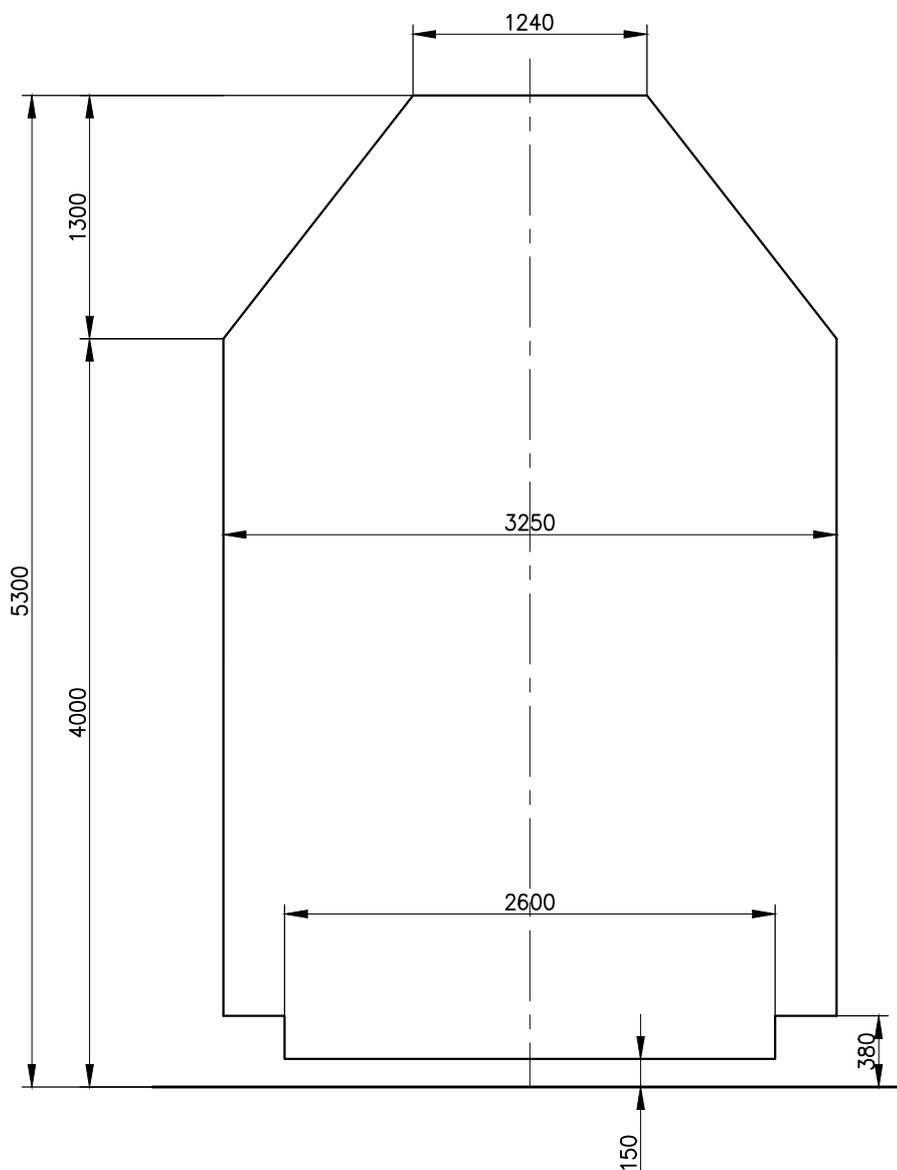
Основной габарит погрузки на железных дорогах колеи 1520 мм:
