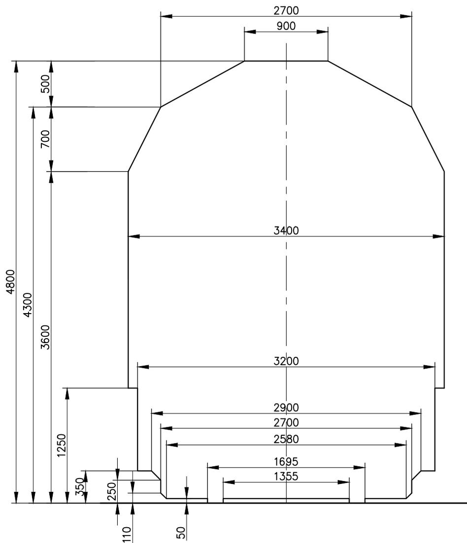
Габарит погрузки на железных дорогах колеи 1435 мм: КЖД
