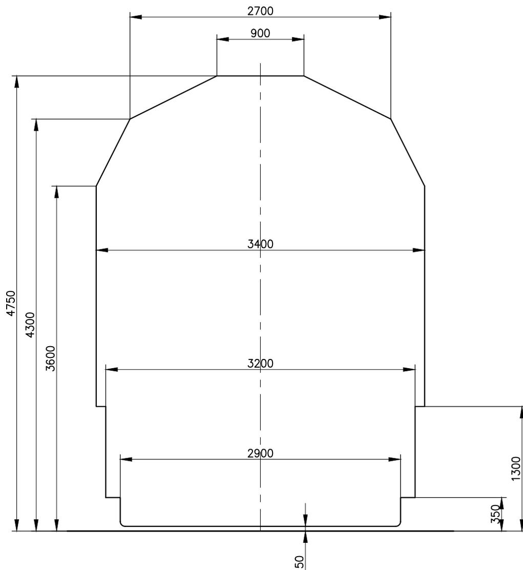
Габарит погрузки на железных дорогах колеи 1435 мм:
